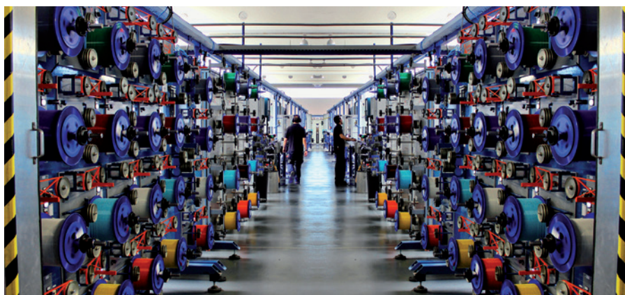
Fábrica de fibra óptica. Línea de protección primaria.
