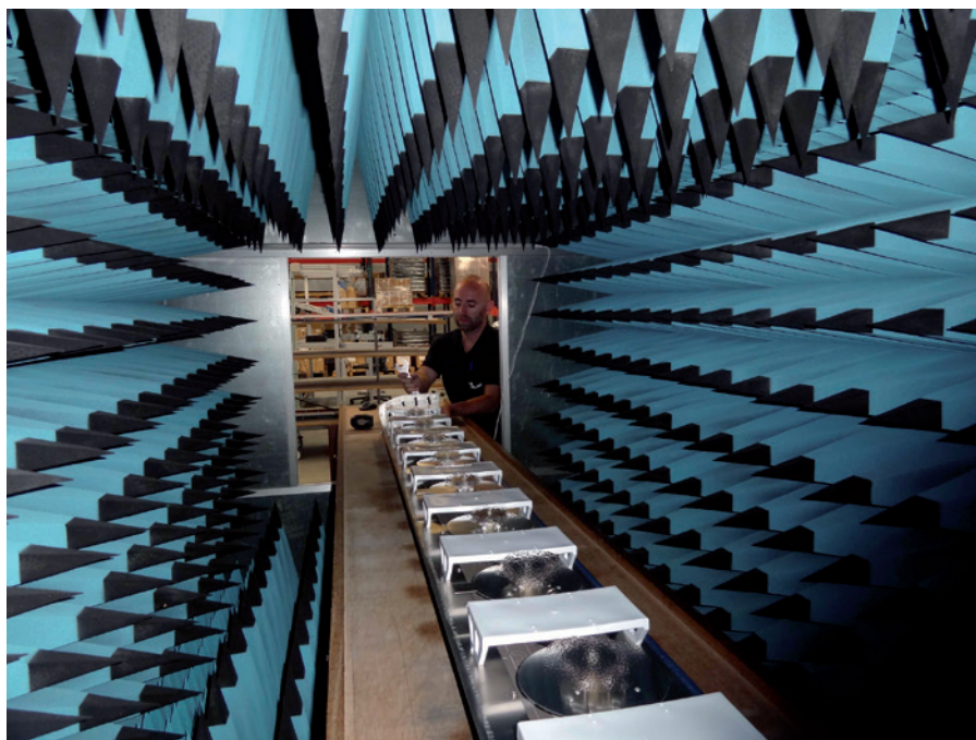
Comprobación de parámetros radioeléctricos de antenas en cámara semianecoica
