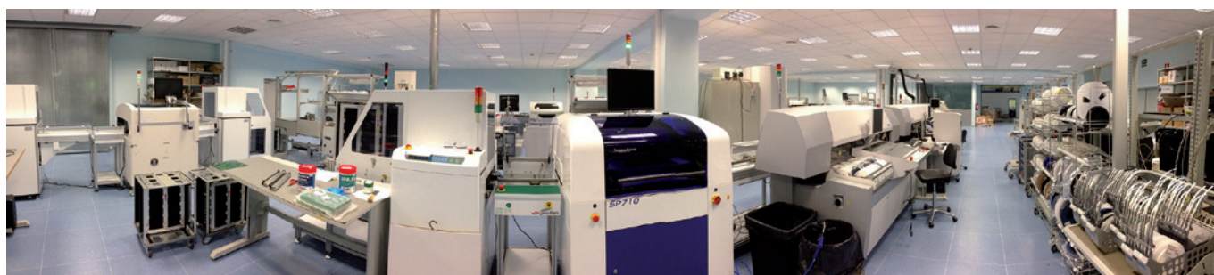
Detalle de una de las líneas versátiles de montaje SMD de la fábrica de equipos de banda ancha
